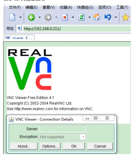
4、在弹出的 VNC Viewer 对话框中再次输入 HMI IP 地址
